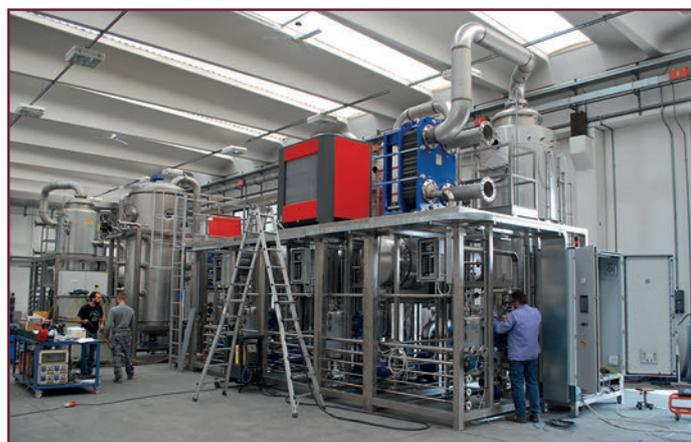
**Figura 1 – Evaporatore a triplo stadio in costruzione.**
