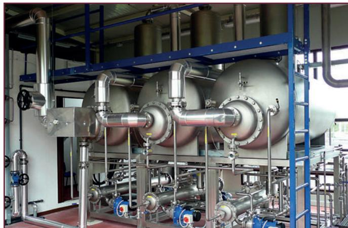
**Figura 5 – Evaporatore triplo stadio della serie ECO DPM.**
