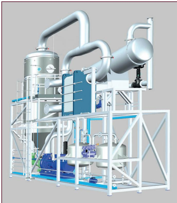
**Figura 4 – Rendering 3D di un impianto specifico per reflui salini.**
