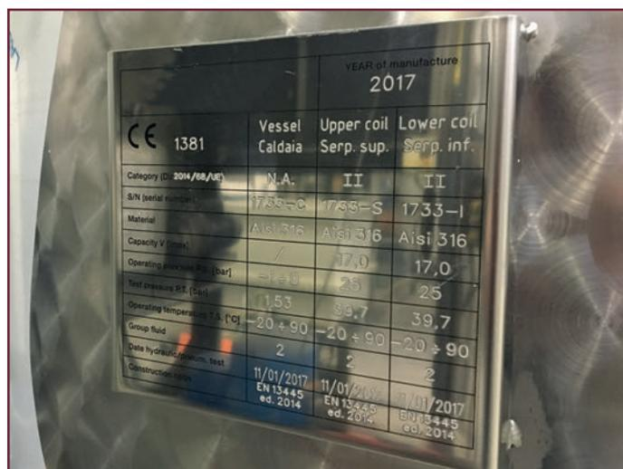
**Figura 2 – Particolare del vessel di un evaporatore con identificazione dei materiali e certificazioni.**
