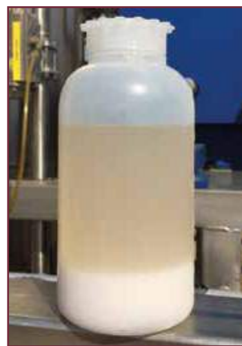
Figura 2 – Campione di concentrato in uscita dall'evaporatore.
