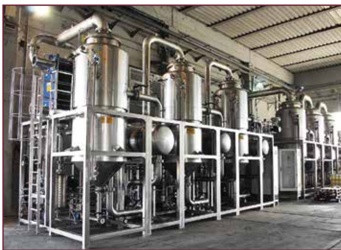
Figura 1 – Due impianti ECO DPM3-SE da 100 m 3 giorno ciascuno.
